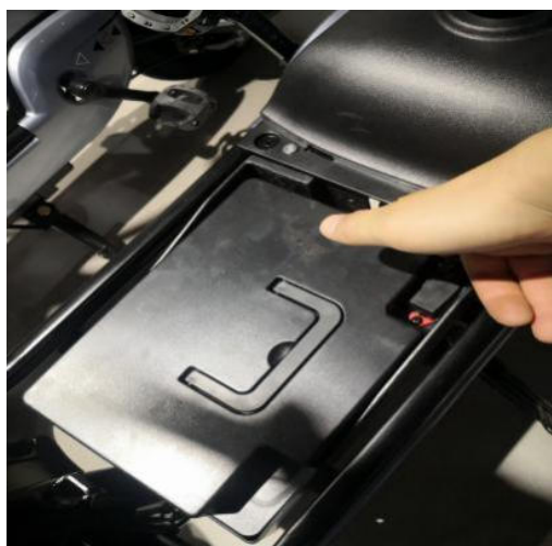
步骤 3：将电池放入舱内，电源线与放电口连接
