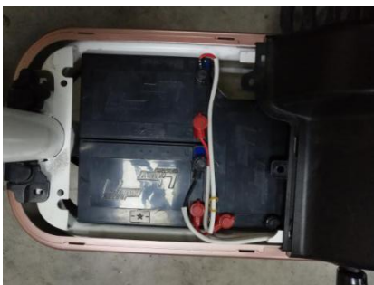
步骤 3：将电池放入舱内，正确把电源线进行连接
