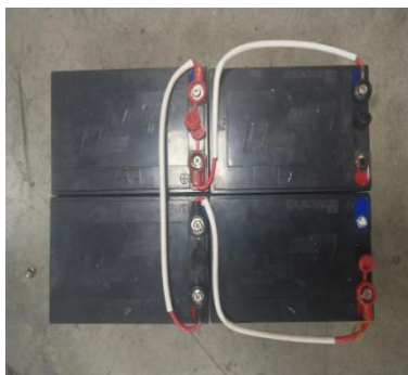
步骤 2：使用电池连接线将电池正确连接在一起
