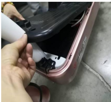
步骤 1：使用螺丝刀将脚踏板打开
