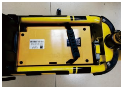
步骤3：把电池线插入电池内接通电源
