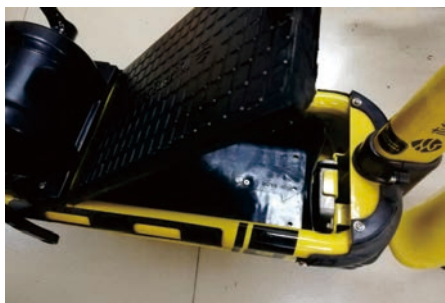
步骤1：用遥控锁打开脚踏板的电池盒盖
