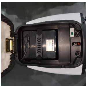
第三步：电源弯头线插入电池插头，合上空气开关
