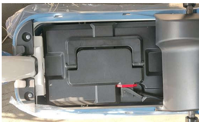
步骤 3：将电池放入舱内，电源线 与放电口连接
