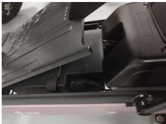
步骤 1：使用钥匙将脚踏板 打开
