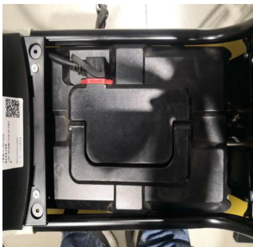
步骤 3：将电池放入舱内，电源线与放电口连接
