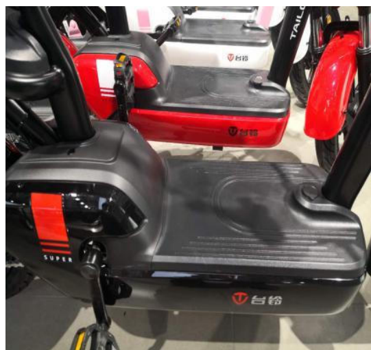
步骤 4：使用钥匙将脚踏板锁紧，安装步骤完成，可以正常使用
