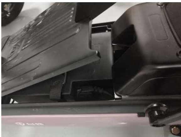
步骤 1：使用钥匙将脚踏板 打开
