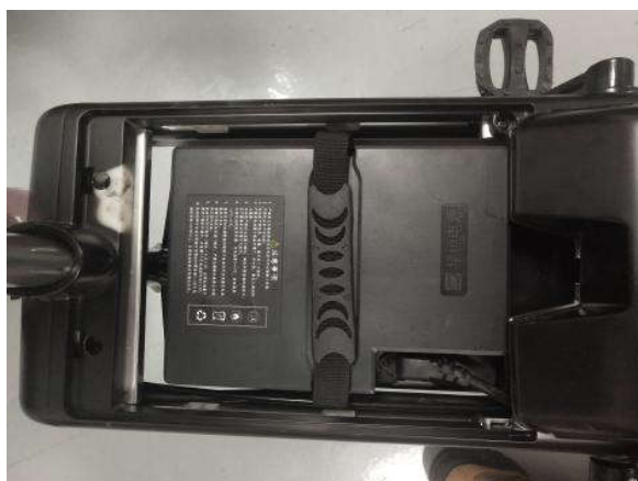
步骤 3：将电池放入舱内，电源线 与放电口连接
