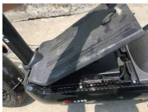
步骤1: 用钥匙打开脚踏板的电池盒盖
