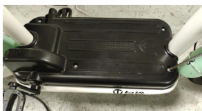
步骤1: 使用螺丝刀将脚踏板打开
