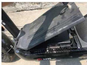
步骤1: 用钥匙打开脚踏板的电池盒盖
