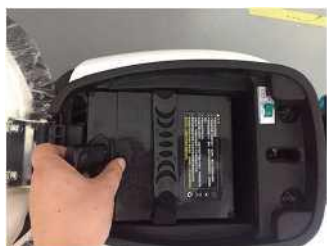
步骤3: 将主线电源线插头 插入电池放电插口处
