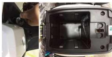
步骤1:用钥匙将坐 垫打开
