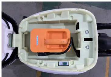
第三步：电源弯头线插入电池插头，合上空气开关
