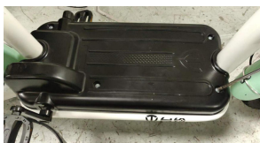
步骤1: 使用螺丝刀将脚踏板打开
