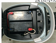
步骤4: 放入第三、四块 电池并按图示连接 电池连接线和电缆线
