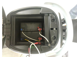
步骤2: 放入第一、二块电池，并 按图示连接电池正负极
