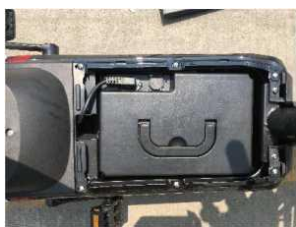
步骤3: 把电池线插入电池内接通电源
