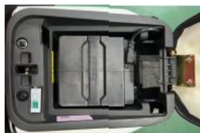
第三步：电源弯头线插入电池插头，合上空气开关
