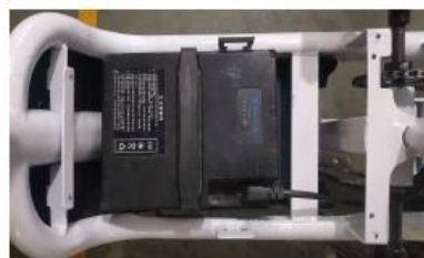
第三步：电源弯头线插入电池插头
