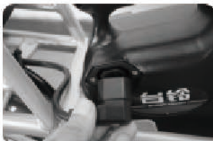
步骤 4: 将主线电源线插头插入电池盒放电插座内
