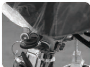
步骤 1: 用钥匙将坐垫锁打开
