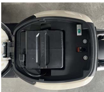
第三步：电源弯头线插入电 池插头，合上空气开关
