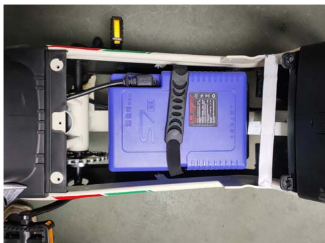
第三步：电源弯头线插入 电池插头
