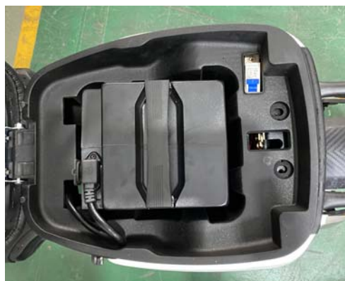
第三步：电源弯头线插入电 池插头，合上空气开关
