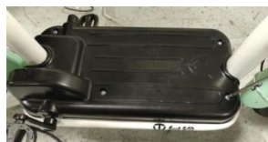
步骤4: 使用螺丝刀紧固脚踏板，安装步骤完成，可以正常使用
