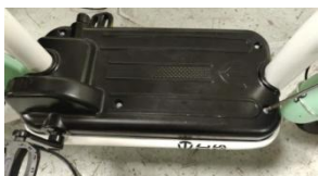
步骤1: 使用螺丝刀将脚踏板打开
