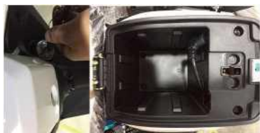
步骤1:用钥匙将坐 垫打开
