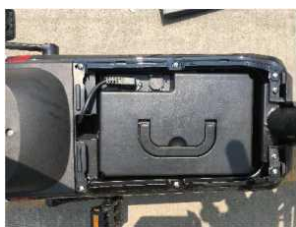
步骤3: 把电池线插入电池内接通电源
