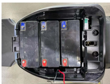
步骤 2: 使用电池连接线将 电池正确连接在一起
