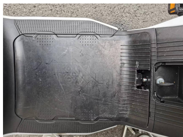
步骤3: 用机械钥匙将电池防盗版锁住。
