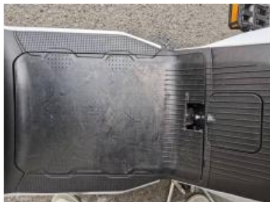
步骤4: 拔出钥匙并闭合钥匙孔盖板
