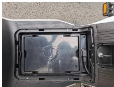
步骤2: 将锂电池放入脚踏板电池 盒内, 并接通电源
