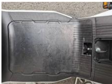
步骤3: 用机械钥匙将电池防盗版锁 住
