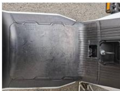
步骤1: 打开钥匙盖板, 用机械钥匙 打开电池防盗版
