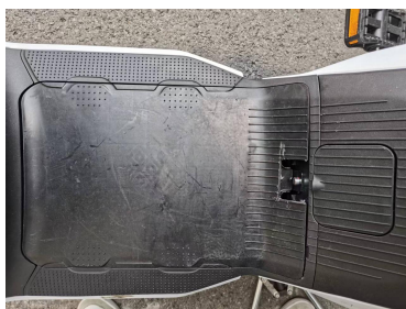
步骤4: 拔出钥匙并合闭钥匙孔盖板
