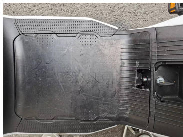
步骤3: 用机械钥匙将电池防盗版锁住。
