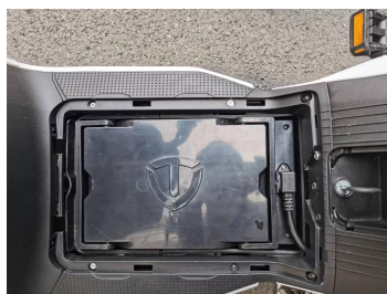
步骤2: 打开电池防盗版，将锂电池装入脚踏板电池盒内，并接通电源
