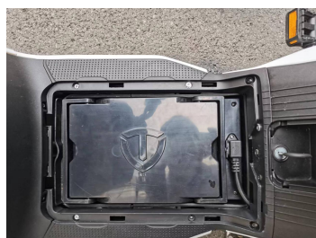
步骤2: 打开电池防盗版，将锂电池装入脚踏板电池盒内，并接通电源
