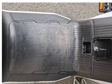
步骤1: 打开钥匙盖板，用机械钥匙打开电池防盗版
