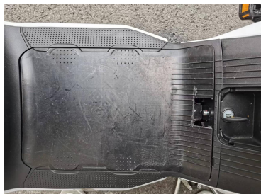
步骤3: 用机械钥匙将电池防盗版锁住。
