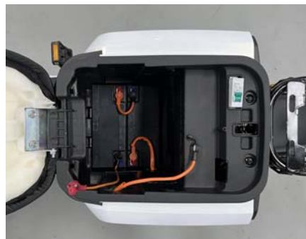
第二步：放入第一、二块电池，并连接电池正极于电缆线，并将一根电池连接线负极固定到蓄电池上
