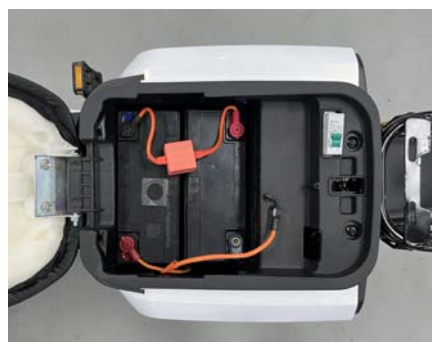
第四步：放入第三、四块电池并于第一、二块电池串联安装如上图所示
