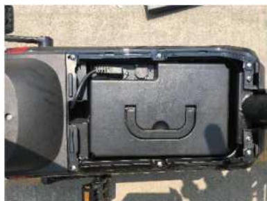
步骤3: 把电池线插入电池 内接通 电源
