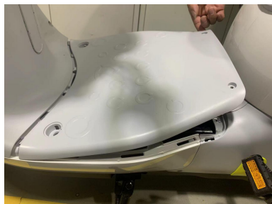
步骤1：松开脚踏板安装螺丝，
