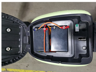
步骤 3: 将电池放入舱内，正确 把电源线进行连接
