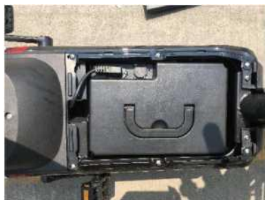
步骤3: 把电池线插入电池 内接通 电源
