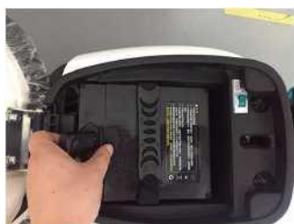
步骤3: 将主线电源线插头插入电池放电插口处
