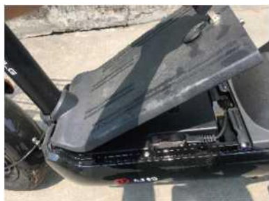
步骤1: 用钥匙打开脚踏板 的电池 盒盖
