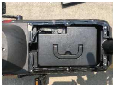
步骤3: 把电池线插入电池 内接通 电源
