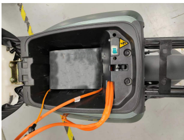
第三步：放入电池缓冲件并将电池上的电池连接线牵引至缓冲件上方
