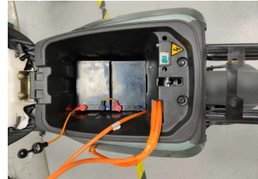
第二步：放入第一、二块电池，并连接电池正极于电缆线，并将一根电池连接线负极固定到蓄电池上
