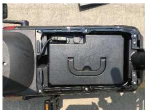
步骤3: 把电池线插入电池内接通电源
