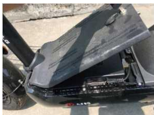
步骤1: 用钥匙打开脚踏板的电池盒盖
