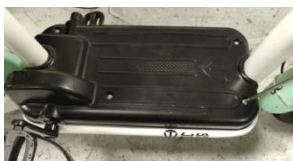
步骤1: 使用螺丝刀将脚踏板打开
