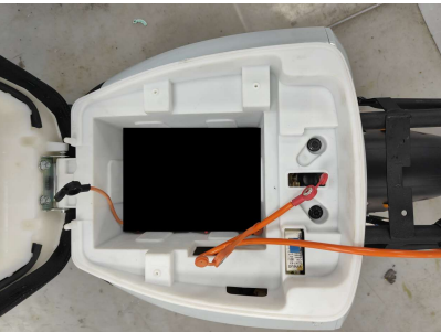
第三步：放入电池缓冲件并将电池上的电池连接线牵引至缓冲件上方
