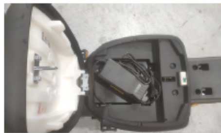
步骤4: 将充电器隔板与充电器装配到位
