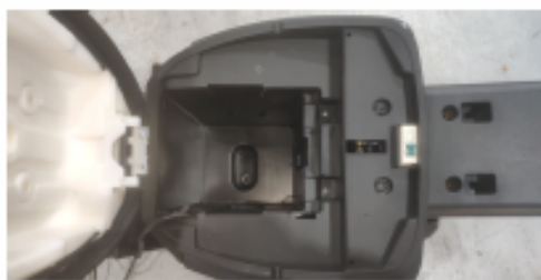
步骤1: 打开座垫并将充电器输出插头与主电缆连接
