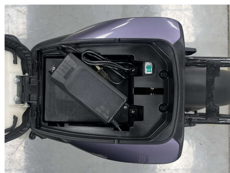
第四步：将充电器隔板与充电器装配到位
