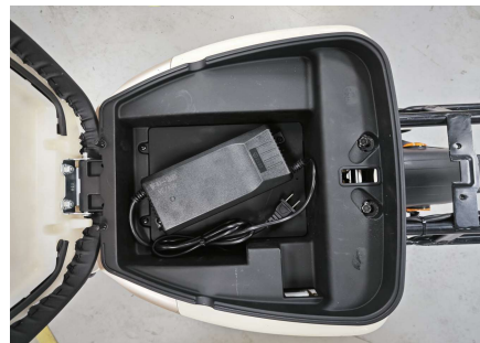
第四步：将充电器输出插头 与主电缆连接，将充电器隔 板与座桶装配到位
