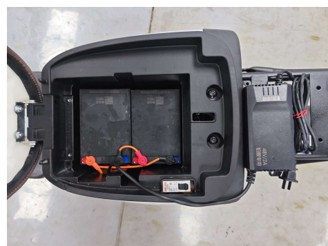
第四步：放入第三块电池并将电池连接线固定安装
