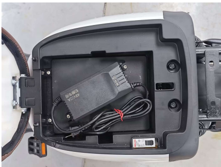
第五步：将充电器隔板与充电器装配到位
