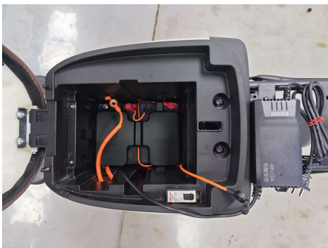
第三步：放入电池缓冲件，电池上的电池连接线牵引至缓冲件上方
