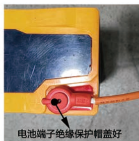
步骤 4: 将电池端子绝缘 保护帽盖好
