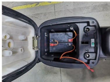
步骤 2: 使用电池连接线将 电池正确连接在一起
