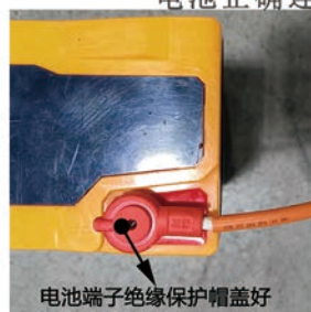
步骤4: 将电池端子绝缘保护帽 盖好
