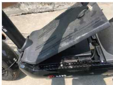
步骤1: 用钥匙打开脚踏板 的电池 盒盖
